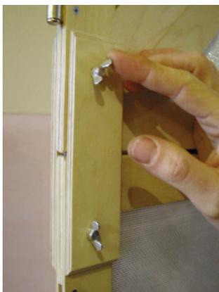
vorderen Kanten über der Knickstelle angebracht. An einem Teil sitzen Stifte mit Innengewinde, die durch Löcher, die sich in der ORAK-Wand befinden, gesteckt werden. Das Gegenstück wird von der anderen Seite dageengehalten und durch Flügelschrauben werden beide Teile miteinander verschraubt.
