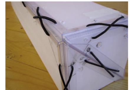
Die für die Gummischnüre nötigen Löcher mussten in die Klemmschienen gebohrt werden, bevor diese auf die Platten aufgeschoben wurden, da es leider nicht möglich war, durch die Drahtgewebe-Schichten zu bohren. Nach dem Aufschieben der Klemmschienen sollten dann Löcher durch die Bohrungen mit Hilfe von zylindrischen Locheisen in
