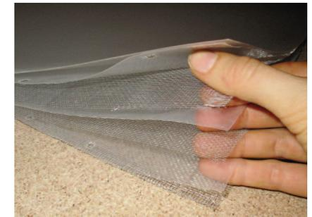
Wobei wir schon beim nächsten Arbeitsschritt wären, dem Zuschnitt der PE-, PP- und Drahtgewebe-Schichten. Um Geld zu sparen, zerlegte ich die Platten, die ich im Rahmen des ersten Entwurfs gebaut hatte wieder in Einzelteile, um das Material für das neue Modell wieder zu verwenden. Auch für den Zuschnitt baute ich mir einfache Hilfskonstruktionen, um nicht jede Fläche abmessen und anzeichnen zu müs-
