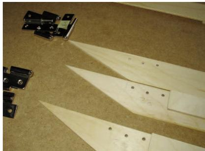
In einige der Leisten, die an der vorderen Seite des ORAK-Körpers sitzen würden, wurden Löcher gebohrt, um an diesen Stellen Scharniere zu befestigen, in die später Türen eingehängt werden sollten.
