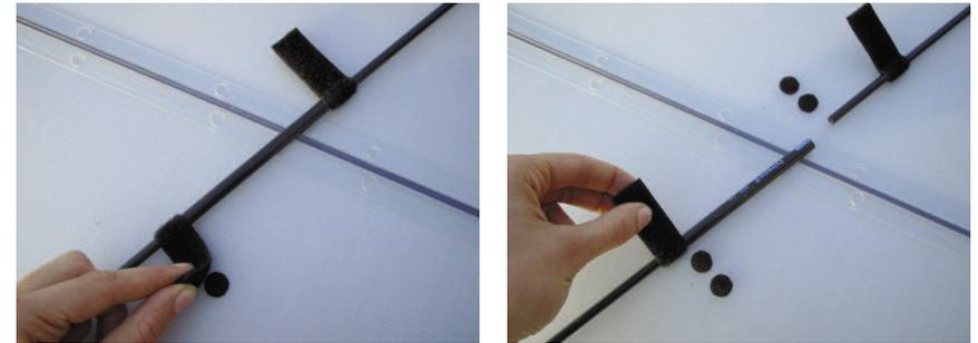
werden, was auch gelang. Kohlefaserrohre wurden, ähnlich wie bei den Scharnieren, mit Schellen aus gebogenem Stahlblech auf der Platte befestigt. In diesen Rohren ruhen wiederum dünnere Rohre, die zur Stabilisierung der Seitenflächen ausgezogen und zusammengesteckt werden können. Sie werden durch Klettverschlüsse in der gewünschten Position gehalten.
