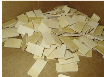
Nachdem die rechteckigen Öffnungen mit Stichsäge und Beitel gefertigt waren, wurden die 176 Einschubelemente aus beidseitig angefasten Leisten ausgesägt. Diese Leisten hatte ich zuvor bereits geschliffen und lasiert.
