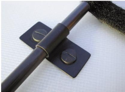
*Die Schellen sind selbstgefertigt. Sie sind durch Kunststoffnieten mit der Platte verbunden.*
