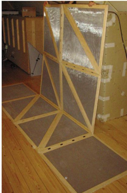
hatte und konnte sehen, dass das faltprinzip grundsätzlich funktionierte. Allerdings wirkten bei einem Gewicht von ca. 14,5 kg größere Kräfte, als ich mir vorgestellt hatte. Ich erkannte, dass die verwendeten Gummibänder sich zu stark dehnten bzw. einen zu geringen Zug ausübten. Sie sollten in der Zukunft durch geeignetere Bänder ersetzt werden. Zunächst konnte ich diesem Mangel ein wenig entgegenwirken, indem ich einige Gummibänder nachspannte.
